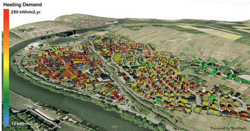
Diagnostic des besoins de chaleur et identification des priorités de rénovation en 3D.
